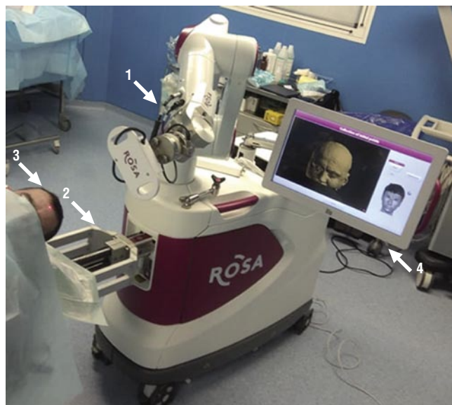
Рис. 2. Роботизированная стереотаксическая система «Rosa» (MEDTECH S.A.): 1 – роботизированная рука-манипулятор роботизированной станции; 2 – держатель для жёсткого фиксатора головы; 3 – голова пациента с наведённой на неё лазерной указкой в процессе бесконтактного распознавания и регистрации лица; 4 – сенсорный дисплей роботической станции.
