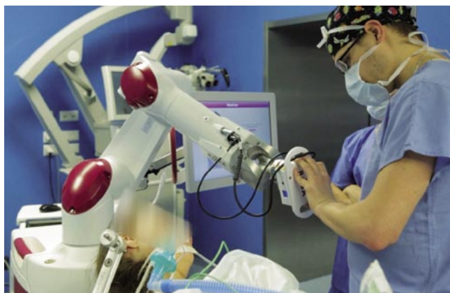
Рис. 9. Бесконтактная лазерная регистрация головы пациента в роботизированной навигационной системе.
