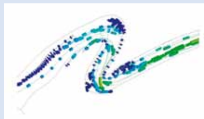
Рис. 6. За счет разницы давления у выпуклой и вогнутой стороны стенки изгиба возникают потоки поперечной циркуляции, имеющие характер завихрения (по Коссович Л.Ю. с соавт.).
